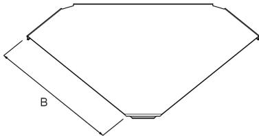
Die schweren Installationskabelrinnen-Bogen-Deckel RIBDS 90° eignen sich für Installationskabelrinnen-Bögen RIB 90° und schützen sie vor Schmutz und Feuchtigkeit. Sie rasten formschlüssig auf den Seitenholmen ein. Sollen die Deckel im Freien eingesetzt werden, sind zusätzliche Sicherungswinkel gegen Windeinflüsse nötig. Der Deckel besteht aus sendzimir-feuerverzinktem Stahl.
