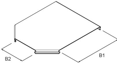
Die Installationskabelrinnen-Abzweig-Deckel RIADS eignen sich für Installationskabelrinnen-Abzweige RIA und schützen sie vor Schmutz und Feuchtigkeit. Sie rasten formschlüssig auf den Seitenholmen ein. Sollen die Deckel im Freien eingesetzt werden, sind zusätzliche Sicherungswinkel gegen Windeinflüsse nötig. Der Deckel besteht aus sendzimir-feuerverzinktem Stahl.
