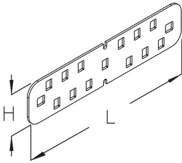
Mit dem Seitenverbinder RGV 60 und dem Bodenverbinder VB lassen sich Kabelrinnen einfach und schnell miteinander verbinden. Auch bei horizontalen und vertikalen Bögen, Kreuzungen, Abzweigen und Reduzierungen kommen Seitenverbinder gemäß Montageanleitung zum Einsatz. Der Seitenverbinder RGV 60 hat eine Höhe von 45 mm und Länge von 190 mm. Verschiedene Materialien und Oberflächen sorgen dafür, dass die Korrosionsanforderungen unterschiedlichster Anwendungsgebiete erfüllt werden.
