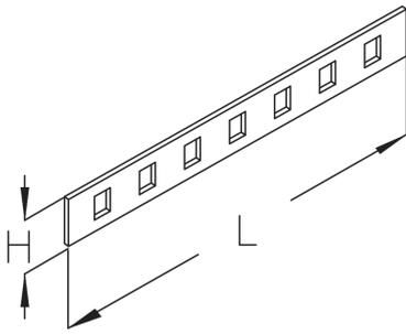
Mit dem Seitenverbinder RGV 35 und dem Bodenverbinder VB lassen sich Kabelrinnen einfach und schnell miteinander verbinden. Auch bei horizontalen und vertikalen Bögen, Kreuzungen, Abzweigen und Reduzierungen kommen Seitenverbinder gemäß Montageanleitung zum Einsatz. Der Seitenverbinder RGV 35 hat eine Höhe von 20 mm und Länge von 150 mm. Verschiedene Materialien und Oberflächen sorgen dafür, dass die Korrosionsanforderungen unterschiedlichster Anwendungsgebiete erfüllt werden.
