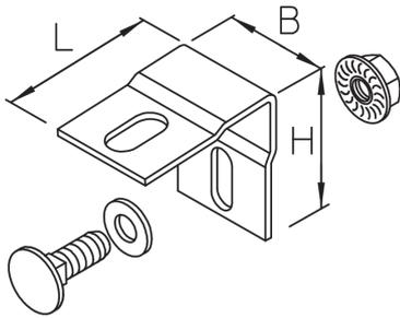
Der Sturmsicherungswinkel RD-SW dient der zusätzlichen Sicherung der Kabelrinnen-Deckel bei Verwendung im Außenbereich. Er wird aufgesetzt und verschraubt. Das notwendige Befestigungsset ist enthalten. Es sind mindestens 6 Sicherungselemente pro 3 Meter Kabelbahndeckel gemäß der Montageanleitung zu verwenden. Verschiedene Materialien und Oberflächen sorgen dafür, dass die Korrosionsanforderungen unterschiedlichster Anwendungsgebiete erfüllt werden.
