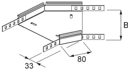
Die Kabelrinnen-Bögen RB45 35 ermöglichen horizontale Richtungsänderungen der Kabelführung um 45°. Sie eignen sich für Kabelrinnen mit Seitenhöhen von 35 mm und verfügen über integrierte Seitenverbinder. Mithilfe eines Bodenverbinders VB wird der Bogen in die Kabelrinne eingeschoben und verschraubt. Verschiedene Materialien und Oberflächen sorgen dafür, dass die Korrosionsanforderungen unterschiedlichster Anwendungsgebiete erfüllt werden.
