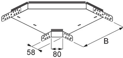
Die Kabelrinnen-Bögen RB 60 ermöglichen horizontale Richtungsänderungen der Kabelführung um 90°. Sie eignen sich für Kabelrinnen mit Seitenhöhen von 60 mm und verfügen über integrierte Seitenverbinder. Mithilfe eines Bodenverbinders VB wird der Bogen in die Kabelrinne eingeschoben und verschraubt. Verschiedene Materialien und Oberflächen sorgen dafür, dass die Korrosionsanforderungen unterschiedlichster Anwendungsgebiete erfüllt werden.
