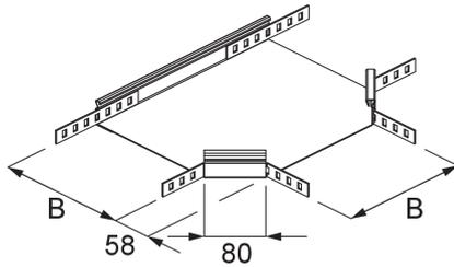
Der Kabelrinnen-Abzweig RA 35 ermöglicht horizontale Richtungsänderungen der Kabelführung in Form eines Abzweigs. Er wird zwischen zwei Kabelrinnen eingesetzt und ermöglicht den Anschluss einer weiteren Kabelrinne im rechten Winkel. Der Kabelrinnen-Abzweig eignet sich für Kabelrinnen mit Seitenhöhen von 35 mm. Verschiedene Materialien und Oberflächen sorgen dafür, dass die Korrosionsanforderungen unterschiedlichster Anwendungsgebiete erfüllt werden.
