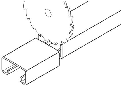
Der Artikel PRS A beschreibt den Zuschnitt unserer Profilschienen der A-Serie, z. B. Profilschiene A 7. Der Artikel PRS B beschreibt den Zuschnitt unserer Profilschienen der B-Serie, z. B. Profilschiene B 3.
