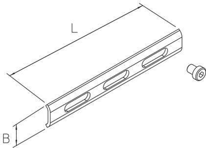
Mithilfe der Lasche MKD-L lassen sich Gitterbahnen der Typen G, GI und GTDW vertikal oder horizontal an Stahlträgern montieren. Zusammen mit der Montageklemme MKD wird die Lasche MKD-L am T-Träger befestigt. Anschließend wird die Gitterbahn entweder mithilfe der Klemmbefestigung KLU oder mit einem Schraubset an der Lasche montiert. Die Lasche MKD-L besteht aus tauchfeuerverzinktem Stahl.
