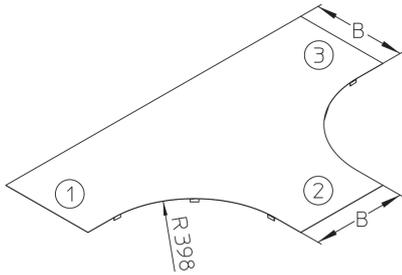
Die Kabelleiter-Abzweig-Deckel LAD eignen sich für T-förmige Kabelleiter-Abzweige und schützen sie vor äußeren Einflüssen wie Schmutz und Feuchtigkeit. Sie werden auf den Abzweigen aufgesetzt. Sollen die Deckel im Freien eingesetzt werden, sind zusätzliche Sicherungswinkel gegen Windeinflüsse nötig. Verschiedene Materialien und Oberflächen sorgen dafür, dass die Korrosionsanforderungen unterschiedlichster Anwendungsgebiete erfüllt werden.
