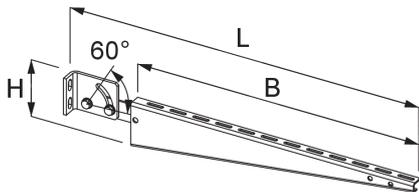
Die Schwenkkonsole KWD ist für den Einsatz an geneigten Wänden bis 60° vorgesehen.
