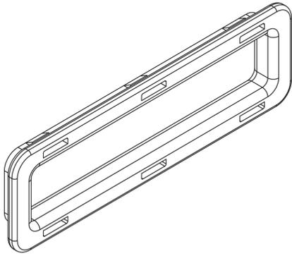
Die Kabelschutzringe KSR 94 aus Polyethylen eignen sich für die gelochten, löschwasserdurchlässigen Kabelrinnen RGL 60. Sie können in die Löcher der Kabelrinnen gesetzt werden und dienen dem Schutz der hindurchgeführten Kabel und Leitungen.
