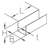
Mithilfe der Kleinkanal-Verbinder KLKV lassen sich Kleinkanäle miteinander verbinden. Sie haben eine Höhe von 30 bis 60 mm, eine Breite von 30 bis 60 mm sowie eine Länge von 150 mm und bestehen aus sendzimir-feuerverzinktem Stahl.
