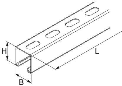
Die Montageschiene KHAL 41 besteht aus einem C+-Profil 41 x 41 mm mit fortlaufender Lochung und einer Schlitzweite von 22 mm sowie einer Materialstärke von 1,5 mm. Verschiedene Materialien und Oberflächen sorgen dafür, dass die Korrosionsanforderungen unterschiedlichster Anwendungsgebiete erfüllt werden. KHAL 41 dient in Kombination mit der Kopfplatte BGA 41 auch als Konsolhalter und ist in Längen bis 6000 mm lieferbar.
