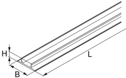
Die Deckleiste KHAD 22 rasten formschlüssig in C-Montageschienen (A 41, KHA 41, KHAL 41) mit 22 mm Schlitzweite und schützen sie vor Schmutz, Berührungen und Feuchtigkeit. Verschiedene Materialien und Oberflächen sorgen dafür, dass die Korrosionsanforderungen unterschiedlichster Anwendungsgebiete erfüllt werden.
