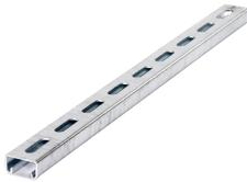
Die Montageschiene JZML K 41/22 wird aus feuerverzinktem Stahl (fv), Edelstahl (A4) oder walzblankem Stahl (wb) hergestellt. Sie bietet eine statische Tragfähigkeit der Normalkraft (NRd) von 7 kN. Die Montageschiene ist in der Standardlänge von 6000 mm lieferbar und wird mit den Schrauben JZS M12 - JZS M16 gepaart. Ihre Profilhöhe beträgt 41 mm, die Profilhöhe 22 mm.
