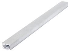
Die Montageschiene JXM W 53/34 besitzt die Umwelt-Produktdeklaration EPD-JDL-20200260-IBB1-DE und wird aus feuerverzinktem Stahl (fv), Edelstahl (A4) oder walzblankem Stahl (wb) hergestellt. Sie bietet eine statische Tragfähigkeit der Normalkraft (NRd) von 43,3 kN und der Querkraft (VRd) von 13,1 kN. Die Montageschiene ist in der Standardlänge von 6000 mm lieferbar und wird mit den Schrauben JXB M16 - JXB M20 gepaart. Ihre Profilhöhe beträgt 53 mm, die Profilhöhe 34 mm.
