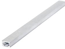
Die Montageschiene JXM W 38/23 besitzt die Umwelt-Produktdeklaration EPD-JDL-20200260-IBB1-DE und wird aus feuerverzinktem Stahl (fv), Edelstahl (A4) oder walzblankem Stahl (wb) hergestellt. Sie bietet eine statische Tragfähigkeit der Normalkraft (NRd) von 18 kN und der Querkraft (VRd) von 5,9 kN. Die Montageschiene ist in der Standardlänge von 6000 mm lieferbar und wird mit den Schrauben JXH M12 - JXH M16 gepaart. Ihre Profilbreite beträgt 38 mm, die Profilhöhe 23 mm.
