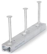
Die Ankerschiene JXA W 53/34 ist europaweit zugelassen mit ETA-09/0338 und nahezu weltweit mit der ICC-ES ESR-2854. Außerdem besitzt sie die Umwelt-Produktdeklaration EPD-JDL-20200260-IBB1-DE. Sie wird aus feuerverzinktem Stahl (fv) oder Edelstahl (A4) hergestellt. Sie ist in jeder gewünschten Länge bis maximal 6 m lieferbar und wird mit den Schrauben JXB M16 - JXB M20 gepaart. Die Profilhöhe beträgt 53 mm, die Profilhöhe 34 mm. Die Füllung ist aus Polyethylen (PE).
