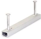
Die Ankerschiene JXA W 29/20 ist europaweit zugelassen mit ETA-09/0338 und nahezu weltweit mit der ICC-ES ESR-2854. Außerdem besitzt sie die Umwelt-Produktdeklaration EPD-JDL-20200260-IBB1-DE. Sie wird aus feuerverzinktem Stahl (fv) oder Edelstahl (A4) hergestellt. Sie ist in jeder gewünschten Länge bis maximal 6 m lieferbar und wird mit den Schrauben JXD M12 - JXD M12 gepaart. Die Profilhöhe beträgt 29 mm, die Profilhöhe 20 mm. Die Füllung ist aus Polyethylen (PE).
