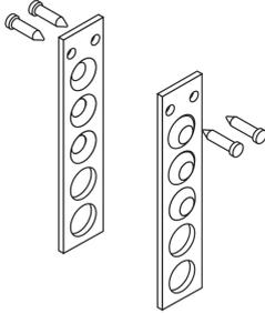
Die Endanker JTBEB sind bauaufsichtlich zugelassen und sichern die Enden von individuell eingekürzten Trapezblechbefestigungsschienen JTB-uni. Sie werden mit selbstschneidenden Bohrschrauben 75 mm vom Schienenende entfernt befestigt.
