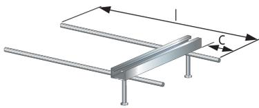
Die Ankerschiene JTA RT W 40/22 wird aus feuerverzinktem Stahl (fv) oder Edelstahl (A4) hergestellt. Die JTA RT W 40/22 verfügt über Rundanker und Bewehrungsstäbe aus Betonstahl. Sie ist in Profillängen von 150 bis 550 mm sowie in mehreren Varianten für die Betonabdeckung erhältlich und wird mit den Schrauben JC M10 - JC M16 gepaart. Die Füllung ist aus Polyethylen (PE).
