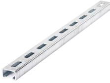
Die Montageschiene JML K 50/40 besitzt die Umwelt-Produktdeklaration EPD-JDL-20200260-IBB1-DE und wird aus feuerverzinktem Stahl (fv), Edelstahl (A4) oder walzblankem Stahl (wb) hergestellt. Sie bietet eine statische Tragfähigkeit der Normalkraft (NRd) von 16,8 kN. Die Montageschiene ist in den Längen 100 bis 6000 mm lieferbar und wird mit den Schrauben JB M10 - JB M20 gepaart. Ihre Profilbreite beträgt 50 mm, die Profilhöhe 40 mm.
