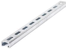
Die Montageschiene JML K 28/15 besitzt die Umwelt-Produktdeklaration EPD-JDL-20200260-IBB1-DE und wird aus feuerverzinktem Stahl (fv), Edelstahl (A4) oder walzblankem Stahl (wb) hergestellt. Sie bietet eine statische Tragfähigkeit der Normalkraft (NRd) von 4,9 kN. Die Montageschiene ist in den Längen 100 bis 6000 mm lieferbar und wird mit den Schrauben JD M6 - JD M12 gepaart. Ihre Profilbreite beträgt 28 mm, die Profilhöhe 15 mm.
