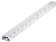
Die Montageschiene JM K 40/25 besitzt die Umwelt-Produktdeklaration EPD-JDL-20200260-IBB1-DE und wird aus feuerverzinktem Stahl (fv), Edelstahl (A4) oder walzblankem Stahl (wb) hergestellt. Sie bietet eine statische Tragfähigkeit der Normalkraft (NRd) von 11,2 kN. Die Montageschiene ist in der Standardlänge von 6000 mm lieferbar und wird mit den Schrauben JC M10 - JC M16 gepaart. Ihre Profilbreite beträgt 40 mm, die Profilhöhe 25 mm.
