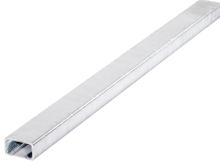
Die Montageschiene JM K 38/17 besitzt die Umwelt-Produktdeklaration EPD-JDL-20200260-IBB1-DE und wird aus feuerverzinktem Stahl (fv), Edelstahl (A4) oder walzblankem Stahl (wb) hergestellt. Sie bietet eine statische Tragfähigkeit der Normalkraft (NRd) von 9,8 kN. Die Montageschiene ist in der Standardlänge von 6000 mm lieferbar und wird mit den Schrauben JH M10 - JH M16 gepaart. Ihre Profilbreite beträgt 38 mm, die Profilhöhe 17 mm.
