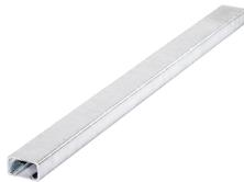
Die Montageschiene JM K 36/20 besitzt die Umwelt-Produktdeklaration EPD-JDL-20200260-IBB1-DE und wird aus feuerverzinktem Stahl (fv), Edelstahl (A4) oder walzblankem Stahl (wb) hergestellt. Sie bietet eine statische Tragfähigkeit der Normalkraft (NRd) von 4,9 kN. Die Montageschiene ist in der Standardlänge von 6000 mm lieferbar und wird mit den Schrauben JH M10 - JH M16 gepaart. Ihre Profilbreite beträgt 36 mm, die Profilhöhe 20 mm.
