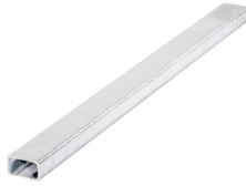
Die Montageschiene JM K 28/12 besitzt die Umwelt-Produktdeklaration EPD-JDL-20200260-IBB1-DE und wird aus feuerverzinktem Stahl (fv), Edelstahl (A4) oder walzblankem Stahl (wb) hergestellt. Sie bietet eine statische Tragfähigkeit der Normalkraft (NRd) von 4,9 kN. Die Montageschiene ist in der Standardlänge von 6000 mm lieferbar und wird mit den Schrauben JD M6 - JD M10 gepaart. Ihre Profilbreite beträgt 28 mm, die Profilhöhe 12 mm.
