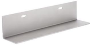
Die Winkelkonsole JL-F+ befestigt Verblender sichtbar. Zugleich deckt sie sowohl die Luftschicht als auch die Dämmung zwischen Fassade und Gebäude vollständig ab. Sie besteht aus rostfreiem Edelstahl der Korrosionsbeständigkeitsklasse III. Sie ist in verschiedenen Kraglängen verfügbar und weist entsprechende Laststufen bis 3,2 kN auf.
