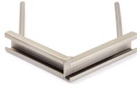
Die Geländerbefestigungsschiene JGB K 40/25 Ecke wird aus feuerverzinktem Stahl (fv) für den Innenbereich oder Edelstahl (A4) für den Außenbereich hergestellt. Die Geländerbefestigungsschiene bietet eine statische Tragfähigkeit der Normalkraft (NRd) von kN und der Querkraft (VRd) von kN. Sie ist in den Längen 100 bis 250 mm lieferbar und wird mit den Schrauben JC M12 - JC M16 gepaart. Ihre Profilbreite beträgt 40 mm, die Profilhöhe 25 mm. Die Füllung ist aus Polyethylen (PE).
