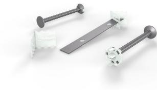
Die Durchstanzbewehrungen JDA-FT-KL 14 sind europaweit mit der ETA-13/0136 für statische und dynamische Einwirkungen zugelassen und besitzen die Umwelt-Produktdeklaration EPD-JDL-20200260-IBB1-DE. Die Doppelkopfanker sind in geripptem Betonstahl erhältlich. Die Leiste wird aus Baustahl und der vormontierte Clip am Ankereslement aus Kunststoff gefertigt. Sonderlösungen sind auf Anfrage erhältlich.
