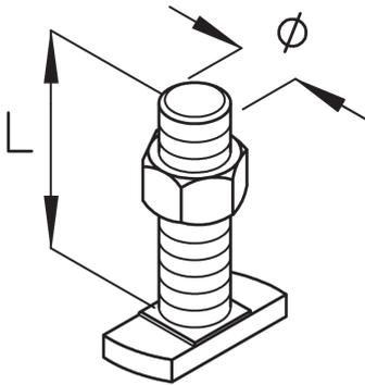
Hammerkopfschrauben HS12 werden bei der Befestigung von Anschlusskonstruktionen an Profil- oder Montageschienen eingesetzt und sind durch eine Hammerkopfform gekennzeichnet. Die Schrauben sind in Längen von 20 bis 40 mm erhältlich und werden inklusive Muttern geliefert. Verschiedene Materialien und Oberflächen sorgen dafür, dass die Korrosionsschutzanforderungen unterschiedlichster Anwendungsgebiete erfüllt werden.
