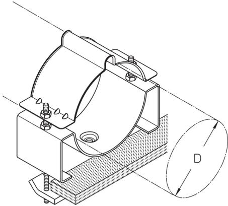
Die HF-Kabelschellen HF-EU 5-6 können Hohlleiter-/Hochfrequenzkabel mit einem Durchmesser bis max. 160 mm führen. Sie eignen sich zur Befestigung an Flachstahlprofilen mit einer Materialstärke bis max. 15 mm. Sie bestehen aus verzinktem Stahl. Zur Aufnahme diverser elliptischer Kabel sind Schelleneinlagen HF-EE zu verwenden.
