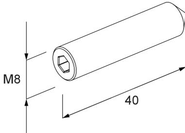
Der Gewindestift GS (gemäß DIN EN ISO 4027) ist in einer Länge von 40 mm sowie mit Gewinde M8 verfügbar und besteht aus Edelstahl.
