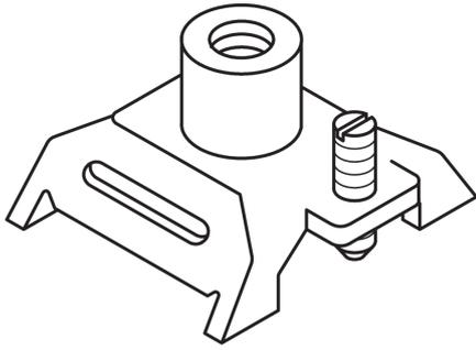
Die Grundplatte GP dient in Zusammenhang mit dem SD Spannband und dem SC Spansschloss dazu, einen Befestigungspunkt mit Gewinde M8 an einer Konstruktion herzustellen. Die Grundplatte GP besteht aus tauchfeuerverzinktem Stahl.
