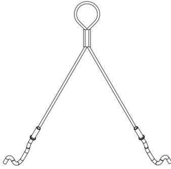
Die Seilabhängung DSAY2AJCT 2 mit Haken und Y-Fit-Zubehör dient der Deckenabhangung von Kabelrinnen. Sie besteht aus galvanisch verzinktem Stahl und ist in Längen von 150 bzw. 300 mm verfügbar. Die maximale Belastung liegt bei 0,44 kN (Grippe Lastklasse 2).
