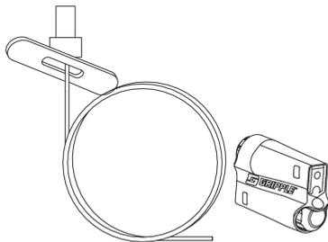
Die Seilabhängung DSAXPSP 2 mit Queranker und Expressverschluss dient der Deckenabhängung von Kabelrinnen und Gitterbahnen. Sie besteht aus galvanisch verzinktem Stahl und ist in Längen von 1000 bis 10000 mm verfügbar. Die maximale Belastung liegt bei 0,44 kN (Grippe Lastklasse 2).
