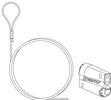
Die Seilabhängung DSAXPFR 2 mit Schlaufe und Expressverschluss dient der Deckenabhängung von Kabelrinnen und Gitterbahnen. Sie besteht aus galvanisch verzinktem Stahl und ist in Längen von 1000 bis 10000 mm verfügbar. Die maximale Belastung liegt bei 0,44 kN (Grippe Lastklasse 2).
