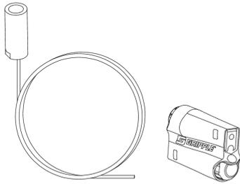
Die Seilabhängung DSAXPET8 2 mit M8-Gewindeübergang und Expressverschluss dient der Deckenabhängung von Kabelrinnen und Gitterbahnen. Sie besteht aus galvanisch verzinktem Stahl und ist in Längen von 1000 bis 10000 mm verfügbar. Die maximale Belastung liegt bei 0,44 kN (Grippler Lastklasse 2).
