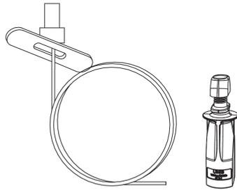
Die Seilabhängung DSAUGSP 2 mit Queranker und UniGrip-Standardverschluss dient der Deckenabhängung von Kabelrinnen und Gitterbahnen. Sie besteht aus galvanisch verzinktem Stahl und ist in Längen von 1000 bis 10000 mm verfügbar. Die maximale Belastung liegt bei 0,54 kN (Grippler Lastklasse 2).
