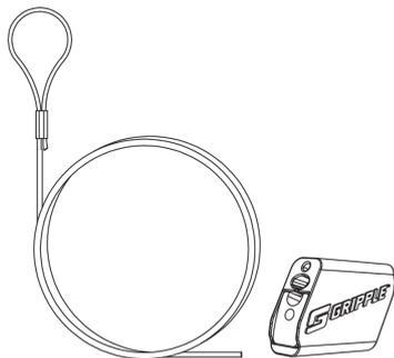
Die Seilabhängung DSAINOXFR 2 mit Schlaufe und Edelstahl-Universalverschluss dient der Deckenabhängung von Kabelrinnen und Gitterbahnen. Sie besteht aus Edelstahl und ist in Längen von 1000 bis 10000 mm verfügbar. Die maximale Belastung liegt bei 0,44 kN (Grippe Lastklasse 2).
