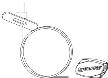
Die Seilabhängung DSAHFSP 3 mit Queranker und Universalverschluss dient der Deckenabhängung von Kabelrinnen und Gitterbahnen. Sie besteht aus galvanisch verzinktem Stahl und ist in Längen von 1000 bis 10000 mm verfügbar. Die maximale Belastung liegt bei 0,88 kN (Grippl Lastklasse 3).
