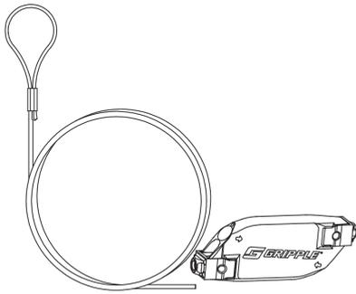
Die Seilabhängung DSAHFFR 5 mit Schlaufe und Universalverschluss dient der Deckenabhängung von Kabelrinnen und Gitterbahnen. Sie besteht aus galvanisch verzinktem Stahl und ist in Längen von 1000 bis 10000 mm verfügbar. Die maximale Belastung liegt bei 3,19 kN (Grippler Lastklasse 5).
