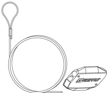
Die Seilabhängung DSAHFFR 4 mit Schlaufe und Universalverschluss dient der Deckenabhängung von Kabelrinnen und Gitterbahnen. Sie besteht aus galvanisch verzinktem Stahl und ist in Längen von 1000 bis 10000 mm verfügbar. Die maximale Belastung liegt bei 2,21 kN (Grippe Lastklasse 4).
