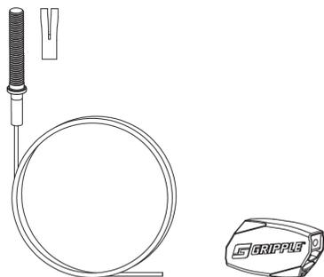
Die Seilabhängung DSAHFEF8 3 mit M8-Gewindeende und Universalverschluss dient der Deckenabhängung von Kabelrinnen und Gitterbahnen. Sie besteht aus galvanisch verzinktem Stahl und ist in Längen von 1000 bis 10000 mm verfügbar. Die maximale Belastung liegt bei 0,88 kN (Gripple Lastklasse 3).
