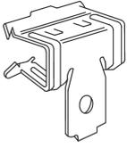
Der Trägerclip DSAGCB kann auf Flachprofilen aufgehämmert werden und lässt sich am besten mit dem Sicherungshaken EC kombinieren. Er besteht aus galvanisch verzinktem Stahl. Die maximale Belastung liegt bei 0,96 kN.
