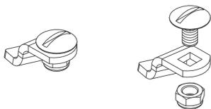
Die Bodenkanal-Drehriegel DR-BK dienen der Befestigung von Bodenkanal-Deckeln auf Bodenkanälen. Insbesondere bei den Bodenkanal-Deckeln BKD-RHP ist die Deckelbefestigung mit Deckelhalteklammern BKDHK oder Drehriegeln DR-BK optional auszuwählen. Hier sind die entsprechenden Butzen auszuslagern und die Drehriegel in das Loch einzusetzen. Der Bodenkanal-Drehriegel DR-BK besteht aus sendzimir-feuerverzinktem Stahl.
