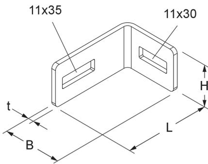
Die Winkellasche BL 4 dient zur Befestigung von Konsolhaltern KHU 40/57/60 an der Wand. Zudem lassen sich mithilfe des Winkels BL 4 die Steigetrassen LGG 60, STU 50, 60 und 62 am Boden, an der Decke oder an der Wand befestigen. Der Winkel wird mit dem Konsolhalter bzw. Steigetrassenholm verschraubt und an die Wand gedübelt. Verschiedene Materialien und Oberflächen sorgen dafür, dass die Korrosionsanforderungen unterschiedlichster Anwendungsgebiete erfüllt werden.
