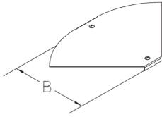
Der variable Bodenkanal-Bogen-Deckel BKVBDR wird auf dem Bodenkanal-Bogen BKVB aufgesetzt und schützt Kabel und Versorgungsleitungen vor Funkenflug und anderen mechanischen Einwirkungen. Er hat eine dem Bogen entsprechende Breite von 100 bis 600 mm. Der Bodenkanal-Bogen-Deckel besteht aus sendzimirfeuerverzinktem Stahl ohne Prägung. Bei einer maximalen Fachgröße von 200 mm garantieren wir eine geprüfte Belastbarkeit von 5,00 kN nach EN 50085-2-2. Drehriegel sind vormontiert.
